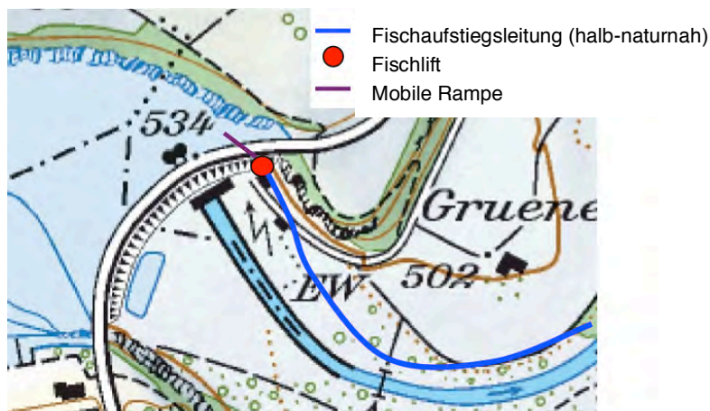
Abbildung 4: Schema des Sanierungsvorschlags für den Fischeufstieg bei der Staumauer Schiffenen (FR.SAA.1).
