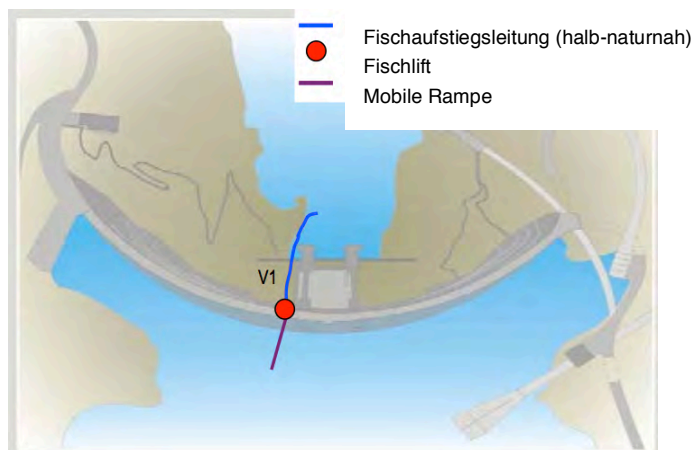
Abbildung 5: Schema des Sanierungsvorschlags für den Fischaufstieg bei der Staumauer Rossens (FR.SAA.9).
